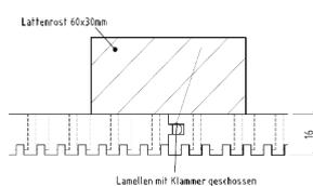
Montage mit Drehclip auf Hutprofil
